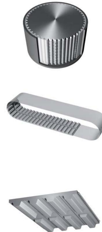
**Polyurethan-Formzahnriemen** (Wickelriemen) werden in speziellen Formen gegossen. Dadurch wird eine hohe Teilungsgenauigkeit über den gesamten Riemen erreicht und sie sind besonders geeignet für einen ruhigen Lauf und hohe Drehzahlen.
