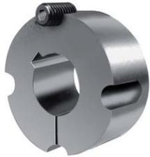
Taperlock-Spannbuchsen sind das standardisierte, handelsübliche Maschinenelement zur Herstellung kraftschlüssiger Welle-Nabe-Verbindungen von Zahnscheiben. Die konisch geschlitzte Spannbuchse mit Passfedernut nach DIN 6885 dient der einfachen Befestigung von Zahnscheiben auf Wellen oder Zapfen.
